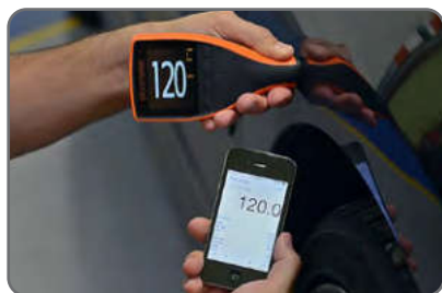
Salida de datos USB y Bluetooth® a iPhone o dispositivos Android™
