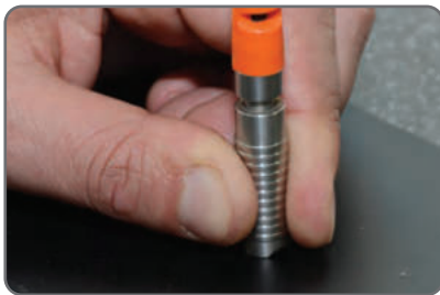
Módulos de sonda con precisión de \pm 1\% o 1\mu\text{m} , la que sea mayor
