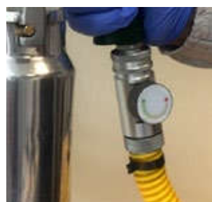
Regulador de producto mediante ruleta con indicador de flujo
