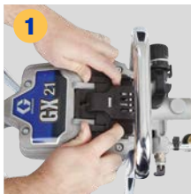
Deslice y levante la tapa de acceso para abrirla
