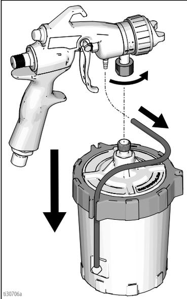
3. Afloje la tuerca que se encuentra en la parte trasera de la pistola. No la quite. Tire del conjunto del alojamiento de la boquilla hacia afuera lo suficiente como para permitir la rotación. Gire el conjunto del alojamiento de la boquilla 180° para que quede orientado hacia arriba.
