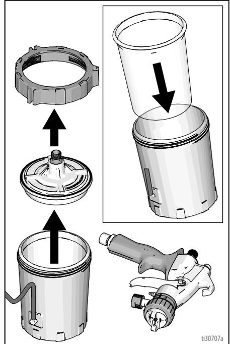
3. Rellene el FlexLiner con material hasta la línea "MAX FILL" (nivel máximo de llenado). Limpie las roscas y las superficies de sellado del sistema FlexLiner.
