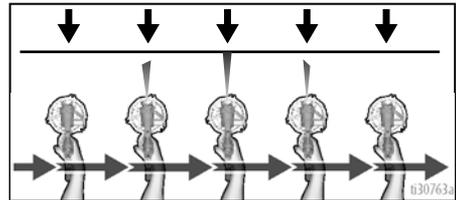
**NOTE:** Para evitar que el chorro de pulverización no sea uniforme, inicie y termine la pasada fuera de la superficie de la pieza de trabajo.
