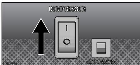
**NOTE:** Si experimenta baja presión de taza remota, desconecte la manguera de aire transparente de la salida del compresor (consulte el paso 2, página 15) y permita que el compresor funcione durante 10 segundos. Vuelva a conectar la manguera de aire.
