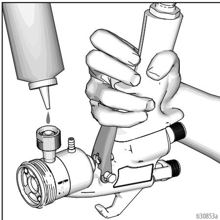
7. Vuelva a instalar la aguja y mueva el deslizador del gatillo desde la posición RETIRADA DE LA AGUJA (B) a la posición PULVERIZACIÓN (A).
