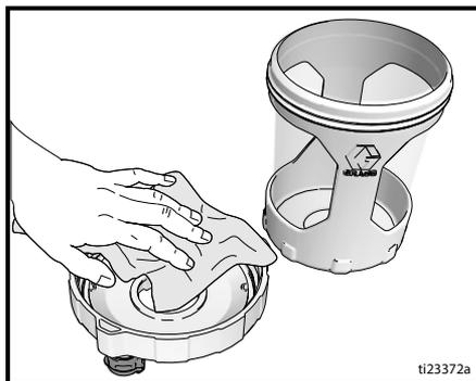
19. Limpie el desinfectante del exterior del pulverizador usando un paño suave humedecido con agua.
