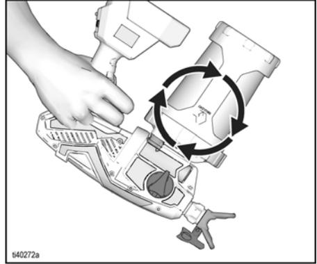
11. Verifique que la boquilla esté hacia delante, en la posición PULVERIZAR. Gire la perilla de cebado hacia delante, a la posición de pulverización (SPRAY).
