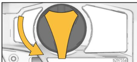
2. Dele la vuelta a la boquilla de pulverización para ponerla en la posición DESOBSTRUIR.
