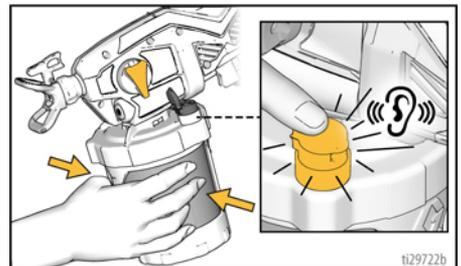
**NOTA:** Si no se estruja el FlexLiner con el tapón VacuValve abierto, se insuflará aire rápidamente en el FlexLiner. Si se ven burbujas de aire en la copa, repita los pasos E-G.
