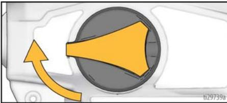
8. Apriete el gatillo para asegurarse de que el equipo pulverice desinfectante. Si no sale material pulverizado antes de 5 segundos, **PARE** el pulverizador y repita la puesta en marcha.
