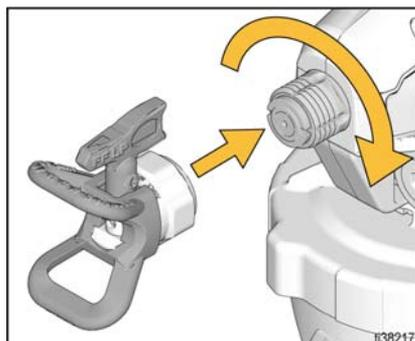
**NOTA:** Las boquillas se desgastan con el uso y hay que cambiarlas periódicamente.
