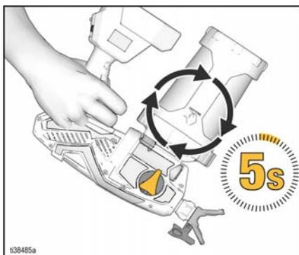
8. Gire la boquilla de pulverización 180 grados, a la posición DESOBSTRUIR. Gire la perilla de cebado hacia delante, a la posición de pulverización (SPRAY).
