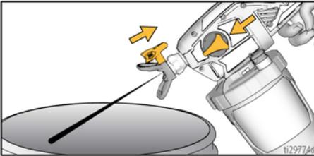
5. Gire la perilla de cebado hacia abajo, a la posición de cebado (PRIME). Gire la boquilla de vuelta a la posición PULVERIZAR. Gire la perilla de cebado hacia delante, a la posición de pulverización (SPRAY), y reanude la pulverización.
