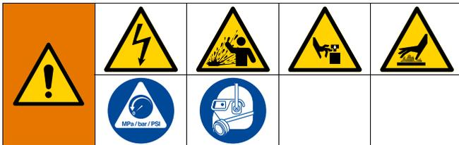
Este equipo seguirá estando presurizado a menos que se descomprima manualmente. Para ayudar a evitar lesiones graves por fluido presurizado, como salpicaduras de fluido y piezas en movimiento, siga el **Procedimiento de descompresión** cuando deje de funcionar y antes de limpiar, comprobar o dar servicio al equipo.
