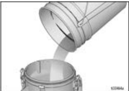
4. Desmonte la boquilla de la pistola. Dispare la pistola hacia el interior de un cubo hasta que haya bombeado la mayor parte de la mezcla de texturado al exterior de la tolva. Permita que el agua fluya a través de la pistola hasta que la pistola esté limpia.
