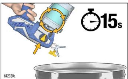
5. Para pulverizar fluido de limpieza, rellene el conjunto de la copa hasta la mitad y vuelva a acoplarlo al pulverizador.
