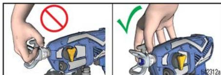
Ajuste el portaboquillas en el sentido deseado de pulverización, vertical u horizontal.
