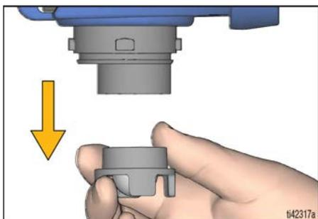
3. Vuelva a instalar el filtro de la bomba. Coloque el pulverizador sobre un trapo.
