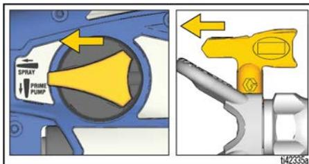
4. Apunte el pulverizador hacia un cubo de desechos y apriete el gatillo durante 5 segundos para pulverizar el fluido de almacenamiento.
