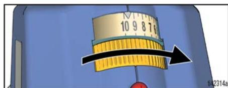
4. Apunte el pulverizador hacia un cubo de desechos y gire la perilla de cebado hacia delante, a la posición de pulverización (SPRAY). Apriete el gatillo durante 5 segundos para eliminar la obstrucción.
