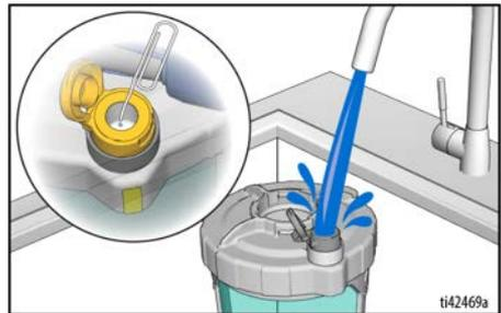
**NOTA:** Asegúrese de limpiar el depósito VacuValve por dentro. Si se obstruye el orificio de aire del VacuValve, límpielo con un clip.
