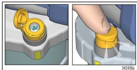
3. Gire la perilla de cebado hacia delante, a la posición de pulverización (SPRAY). Verifique que la boquilla esté hacia delante, en la posición PULVERIZAR.
