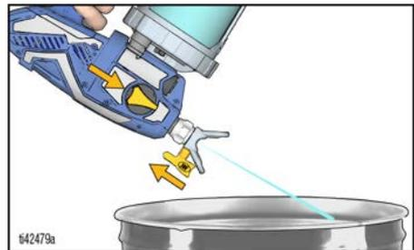
9. Gire la válvula de cebado hacia abajo, a la posición de cebado (PRIME), para aliviar la presión del sistema, y vuelva a poner la posición de pulverización (SPRAY) inmediatamente para guardarla. Quite la batería.
