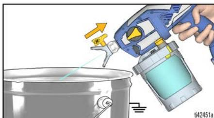
**NOTA:** Si la boquilla de pulverización sigue estando obstruida, quizás deba repetir los pasos 1-4 o sustituirla por una boquilla de repuesto.
