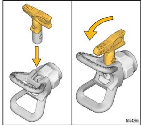
5. Enrosque el conjunto del portaboquillas en el pulverizador y apriete con la mano.
