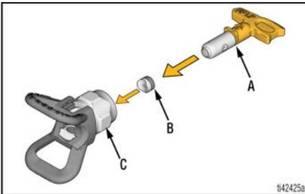
4. Inserte la boquilla de pulverización. La boquilla de pulverización debe empujarse hasta el fondo del portaboquillas.
