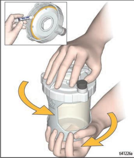
3. Ponga el embudo en la tapa de la copa y gírelo para bloquearlo. Encaje el colador en el embudo para colar la pintura a medida que llena la copa.
