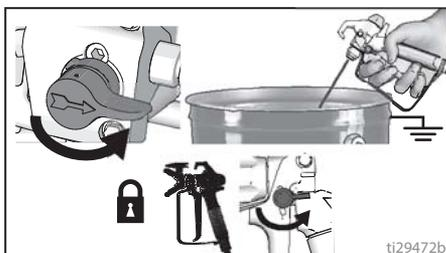
12. Gire la perilla de control de presión a la configuración de presión mínima y gire el interruptor de encendido/apagado a la posición **OFF**. Desconecte la alimentación eléctrica del pulverizador.
