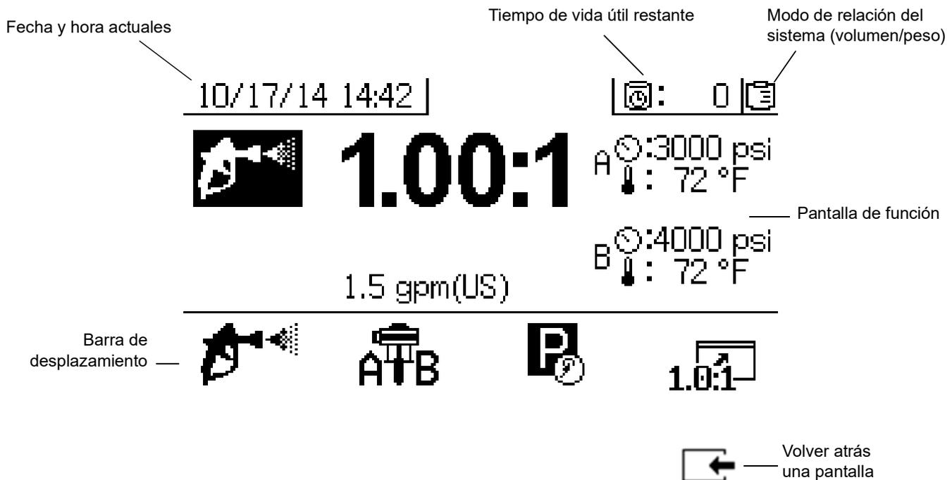
**Fig. 6: Componentes de la pantalla principal (mostrados con todas las funciones de pantalla habilitadas)**
