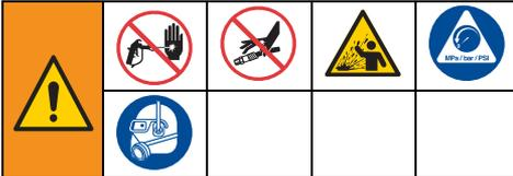
El equipo seguirá presurizado hasta que se libere manualmente la presión. Para evitar lesiones graves por fluido presurizado, como la inyección en la piel, salpicaduras de fluido y las ocasionadas por piezas en movimiento, siga el Procedimiento de descompresión cuando deje de pulverizar y antes de limpiar, revisar o realizar el mantenimiento del equipo.
