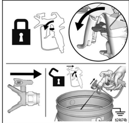
2. Coloque el seguro del gatillo. Vuelva a colocar la boquilla de pulverización en su posición original. Quite el seguro del gatillo y siga pulverizando.
