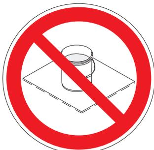
**Siempre conecte a tierra un bidón de metal:** conecte un cable de conexión a tierra al bidón. Conecte un extremo al bidón y el otro a una conexión a tierra verdadera, tal como una tubería de agua.
