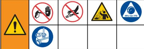
El equipo seguirá presurizado hasta que se libere manualmente la presión. Para evitar lesiones graves por fluido presurizado, como la inyección en la piel, salpicaduras de fluido y las ocasionadas por piezas en movimiento, siga el Procedimiento de descompresión cuando deje de pulverizar y antes de limpiar, revisar o realizar el mantenimiento del equipo.
