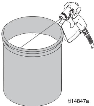
7. Gire la válvula de cebado hacia abajo a la posición de DRENAJE y permita que el fluido de lavado circule hasta que el fluido de lavado aparezca limpio.
