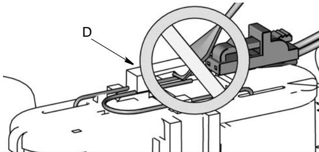
4. **Únicamente medidores Prefijado y Matrix 15:** Desenganche el conector del solenoide (C) (FIG. 4).
