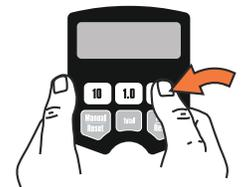
Para reiniciar la pantalla a 0.00, presione y mantenga presionada la tecla *Manual / Reiniciar*.
