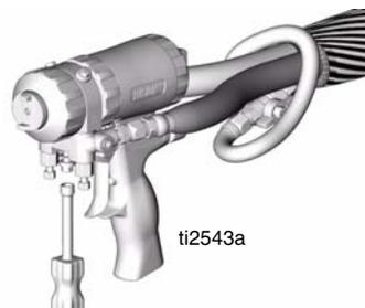
4. Fije las válvulas de ALIVIO DE PRESIÓN/ PULVERIZAR (SA, SB) en PULVERIZAR.
