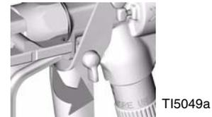
6. Drene el fluido. Para drenar el fluido, abra lentamente todas las válvulas de drenaje de fluido, incluyendo la válvula de drenaje/purga (J) del sistema en el interior de un cubo de desecho. Si hubiera un tubo de retorno, abra la válvula esférica de la línea de retorno.
