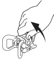
5. Retire la protección y la boquilla de giro SwitchTip.
