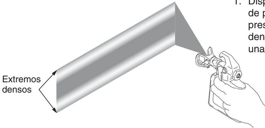
1. Dispare la pistola y pulverice la plantilla de prueba. Regule lentamente la presión para suprimir los extremos densos. Si no logra hacerlo, utilice una boquilla más pequeña.
