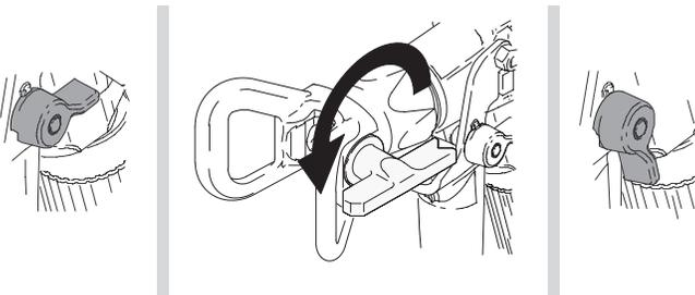
2. Enganche el seguro del gatillo, vuelva a colocar la boquilla de giro SwitchTip en su posición original, suelte el seguro del gatillo y siga pulverizando.
