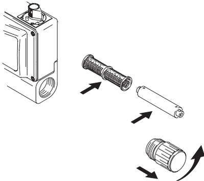
8. Si el pulverizador tiene un filtro, desenrosque la cubeta, retire el conjunto del filtro. Vuelva a montar sin el filtro y limpie éste.
