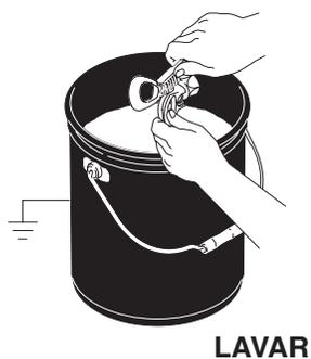
17. Limpie la boquilla, la protección y la junta con un cepillo suave para evitar su deterioro debido a la acumulación de producto seco. Ensamble las piezas y sujételas, sin apretarlas demasiado, en la pistola.
