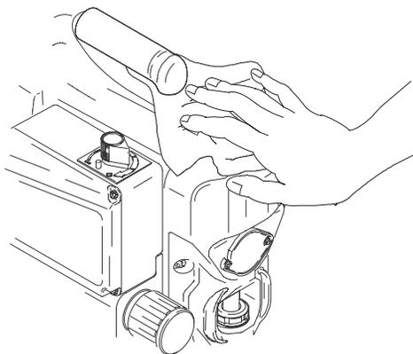
16. Frote el pulverizador, la manguera y la pistola con un paño empapado en agua o alcohol mineral.
