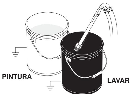
14. Suba el tubo de aspiración por encima del líquido de lavado y haga funcionar el pulverizador durante 15 a 30 segundos para drenar el líquido. **Apague** la fuente de alimentación.
