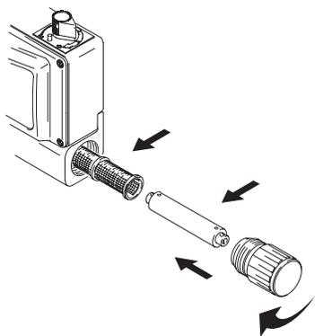
15. Instale la cubeta del filtro y el conjunto del filtro. Apriete a mano la cubeta del filtro. Instale el conjunto del filtro en la pistola. Apriete a mano la empuñadura de la pistola.
