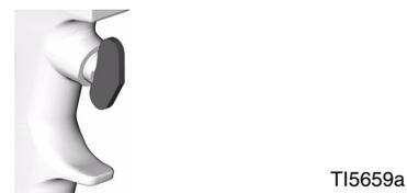
**6.** Cierre la válvula de lavado del lado de la resina (K). Abra la válvula de lavado del endurecedor (L). Siga lavando hasta que el disolvente salga limpio.
