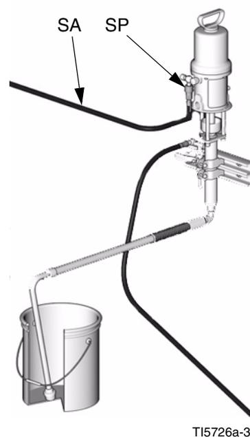
**FIG. 6: Conecte las líneas de aire**
