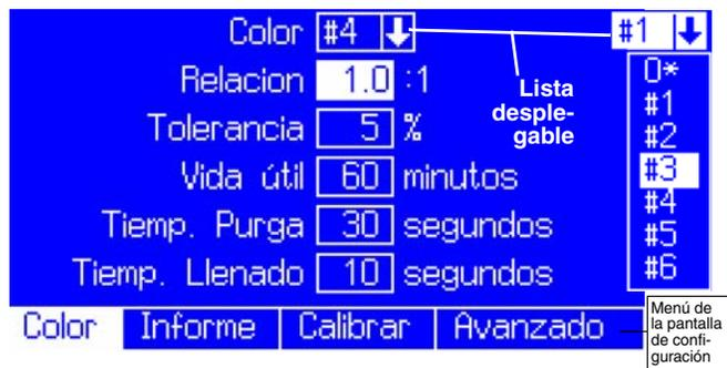
FIG. 33 Modo de configuración – Pantalla de configuración del color
