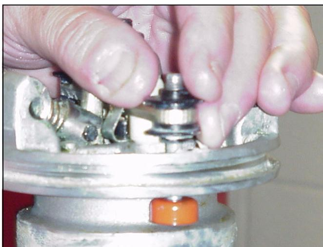
15. Alinee los orificios de las tuercas de la válvula (24\*) y las ranuras de los vástagos de las válvulas de vástagos (32\*) e instale los cables de bloqueo (25\*) a través de los orificios de las tuercas de las válvulas superior e inferior. Para más detalles, vea FIG. 1, página 36.
