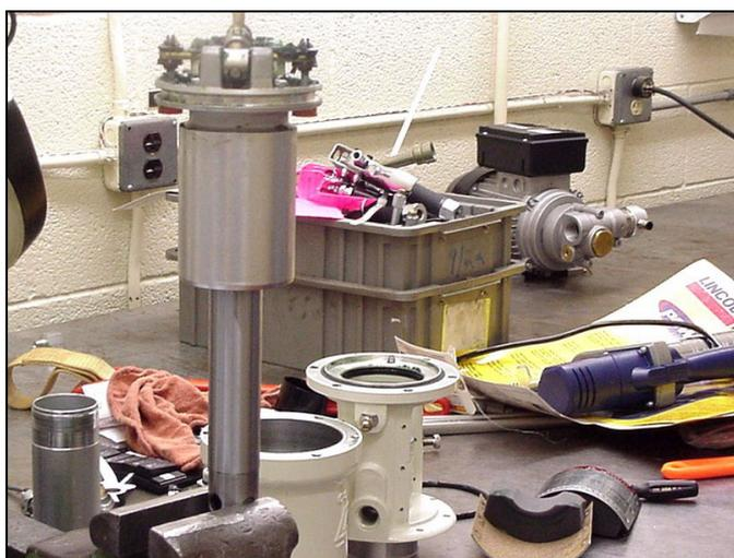
27. Retire la empaquetadura de la junta tórica (18\*) del pistón del motor neumático (34).
