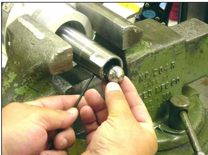
12. Retire la junta tórica prensaestopas (11\*) del pistón del fluido (43).
