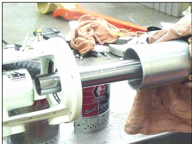
24. Deslice cuidadosamente el cilindro del motor neumático (35), sin torcerlo, hasta el pistón del motor neumático (24).
