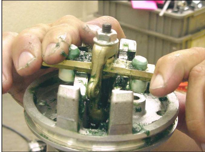
10. Enrosque las tuercas de la válvula superior (24\*) en los vástagos de la válvula de entrada (32\*) hasta que enganchen.
