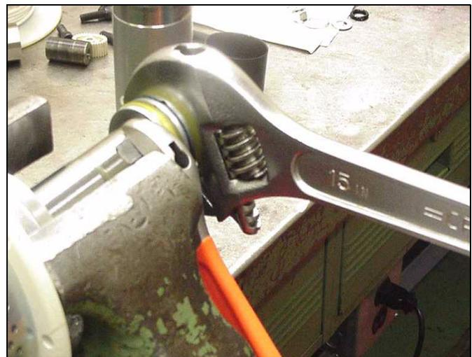
11. Retire la bola metálica (6) del extremo del eje del pistón (29).
