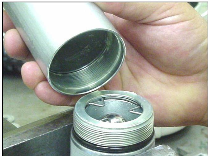
6. Retire el retén de bola e inspeccione la bola metálica (8), el retén de bola (44), y el asiento del alojamiento de la válvula (42) en busca de daños.
