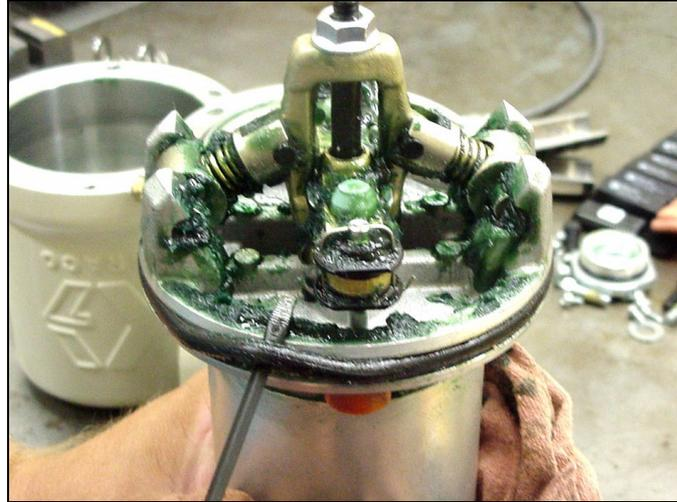
28. Utilice el asa de un destornillador para empujar hacia abajo la horquilla del eje de desenganche (23) y presionar hacia abajo las piezas basculantes (38).
