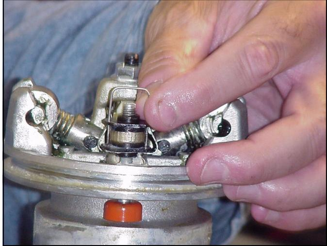
16. Tire hacia abajo de los cables de bloqueo (25\*) para tensarlos, y doble los extremos con los alicates de aguja de forma que no puedan volver a salir por los orificios.
