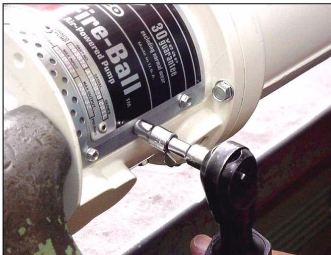
19. Retire los seis tornillos de cabeza hexagonal (7) que sujetan la placa de advertencia (47) a la base del motor neumático (28).
