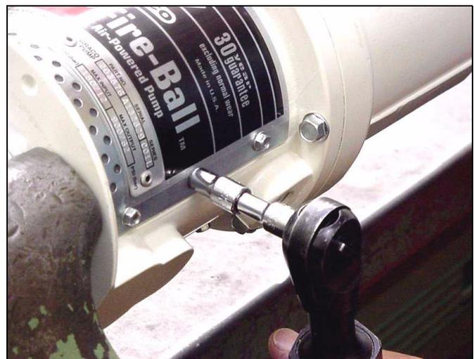
30. Reemplace los seis tornillos (7) que sujetan la placa de advertencia (47) a la base del motor neumático (28).
