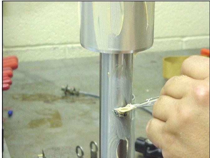
23. Deslice el eje del pistón (29) a través de las empaquetaduras, y deslice el pistón del motor neumático (34) hasta su base (28).
