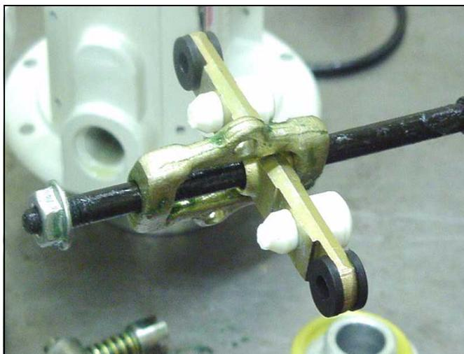
8. Engrase abundantemente y coloque la varilla de disparo (40) en el pistón del motor neumático (34) pasando los vástagos de las válvulas de vástago (32\*) a través de los ojales de la válvula inferior (17\*).
