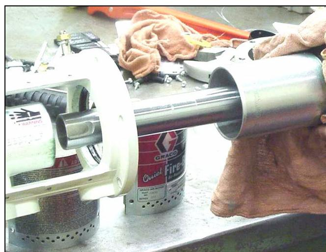
23. Retire la empaquetadura de la junta tórica (12\*).
