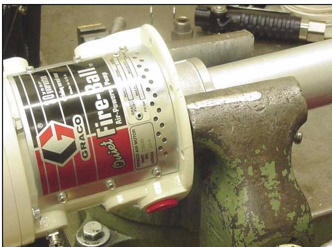
3. Sujete el cilindro de fluido (41) con una llave de cinta o una llave de cadena para desenroscarlo de la base del motor neumático (28).
