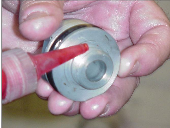
34. Enrosque el pistón de fluido (43) en el eje del pistón (29). Apriete a un par de 54 a 81 N.m.
