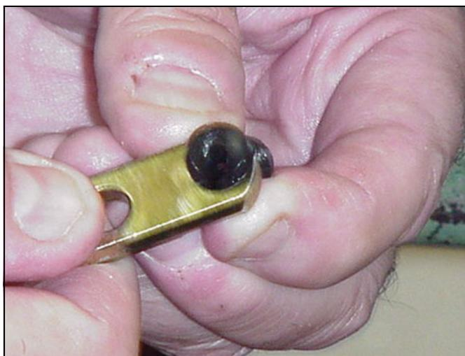
3. Tire de las nuevas válvulas de vástago (31\*) introduciéndolos en el actuador de la válvula (27).
