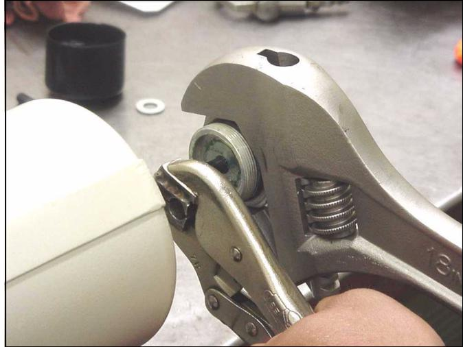
28. Enrosque la tapa del cilindro (39) en la parte superior del cilindro.
