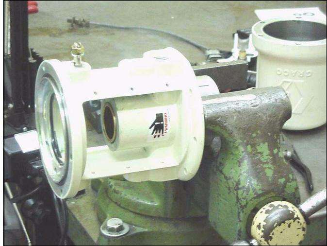
22. Engrase la parte exterior del pistón del motor neumático (34) y el eje del pistón (29).
