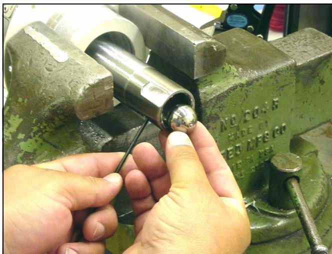
32. Instale la nueva empaquetadura de la junta tórica (11\*) en el pistón de fluido.
