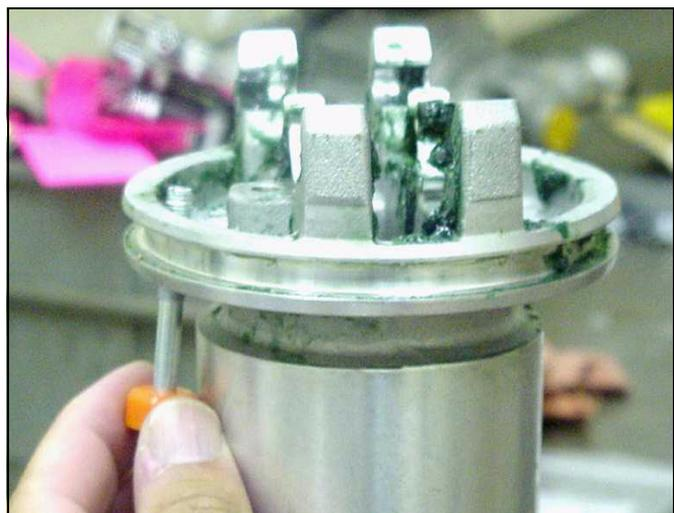
6. Enrosque las tuercas de la válvula inferior (24\*) en los vástagos de las válvulas de vástago, hasta falten unas pocas vueltas para pasarse de rosca.
