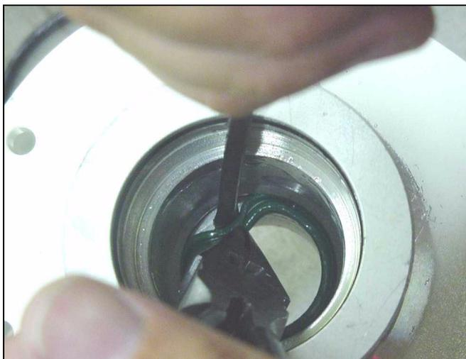
25. Retire la empaquetadura de la junta tórica (13\*) de la base del motor neumático.
