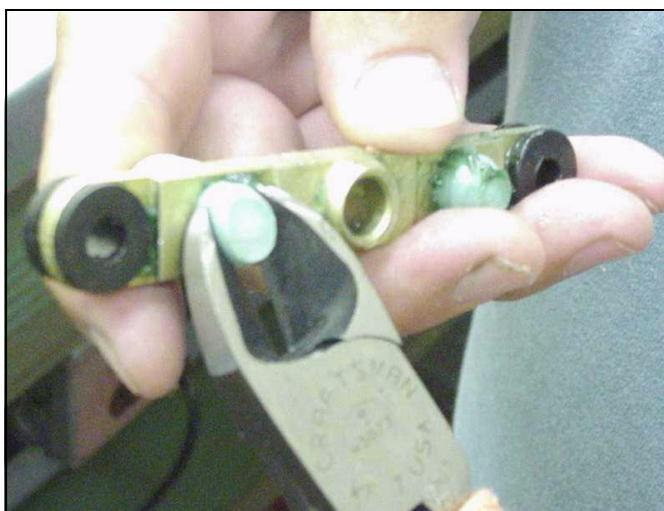
38. Para retirar los ojales de la válvula inferior (17\*) córtelos con un cuchillo afilado o una cuchilla.
