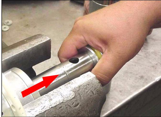
10. Coloque llaves en las partes planas del eje del pistón (29) y en las partes planas del pistón de fluido (43), y desenrosque el pistón de fluido del eje del pistón.
