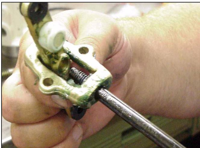
37. Para retirar los vástagos de la válvula (31\*) córtelos con un cuchillo afilado o una cuchilla.
