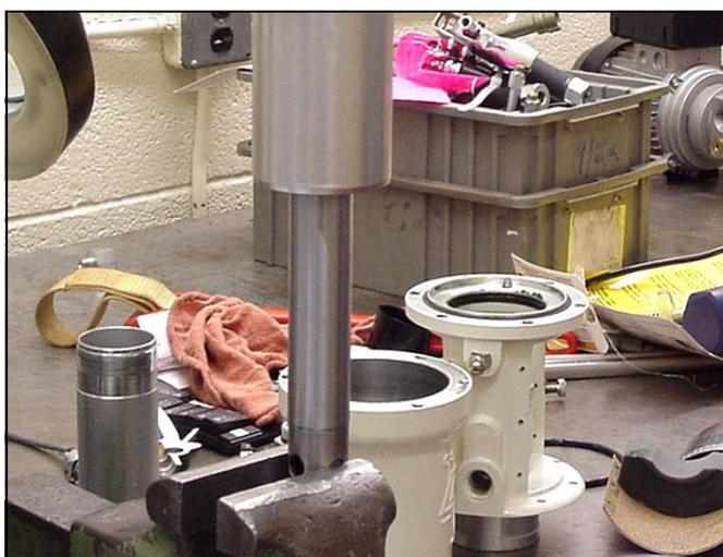
2. Instale los nuevos ojales de la válvula inferior (17\*) en el actuador de la válvula (27).
