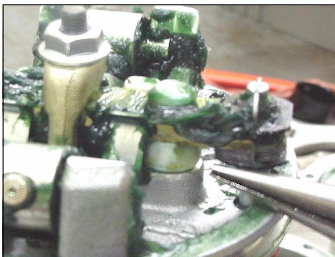
33. Retire los cables de bloqueo (25\*) de las tuercas de las válvulas (24\*).
