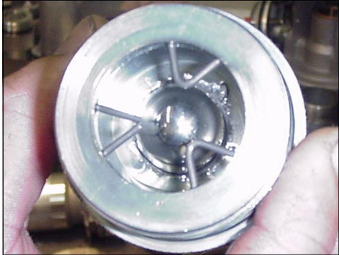
7. Retire y reemplace las empaquetaduras de la junta tórica (21\*).
