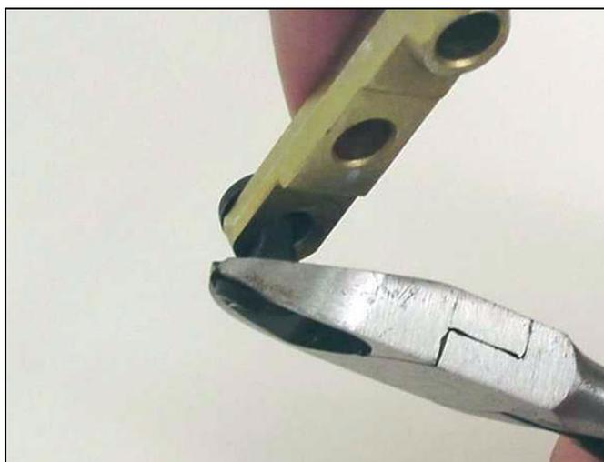
39. Desenrosque y desmonte las tuercas de la válvula inferior (24\*) y la válvula de vástago (32).
