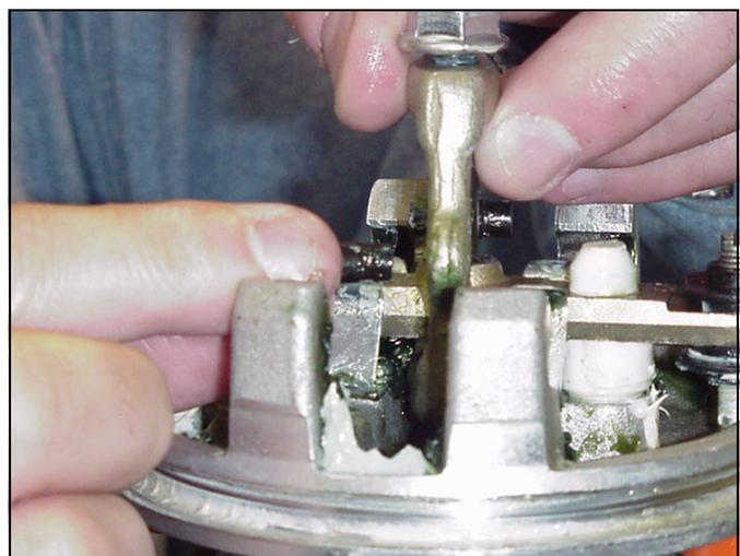
12. Coloque los extremos del brazo basculante (38) del conjunto basculante en los pasadores basculantes (36), y encaje los extremos del pasador pivotante del conjunto basculador en las orejetas del pistón.
