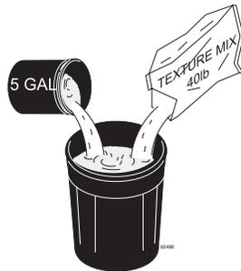
2. Agite para mezclar utilizando un taladro de media pulgada, de velocidad variable, con una paleta de mezcla, hasta conseguir una consistencia uniforme y sin grumos.
