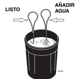
5. Si la bola no se hunde completamente en la mezcla en menos de 10 segundos, añada más agua, agite y vuelva a realizar el ensayo.
