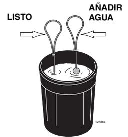
6. Si la bola no se hunde completamente en la mezcla en menos de 10 segundos, añada más agua, agite y vuelva a realizar el ensayo.
