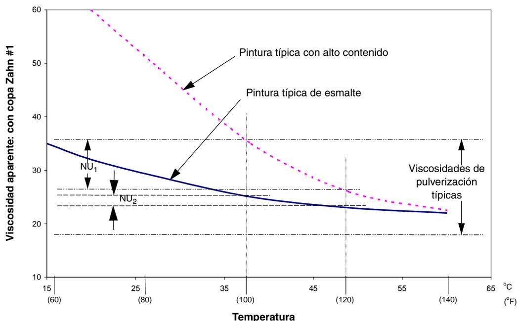
**FIG. 10: Efecto de la temperatura sobre la viscosidad**
