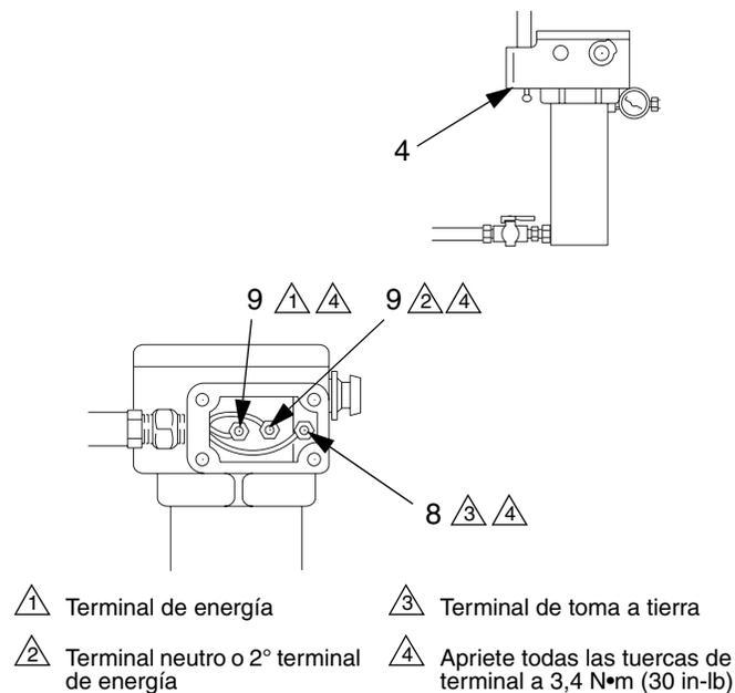
**FIG. 8: Cableado para el montaje en carro**
