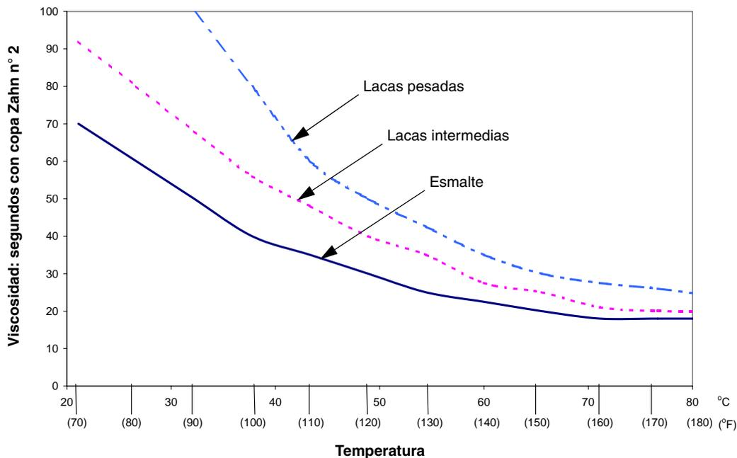
**FIG. 9: Reducción de la viscosidad: Método Under-Boil**
