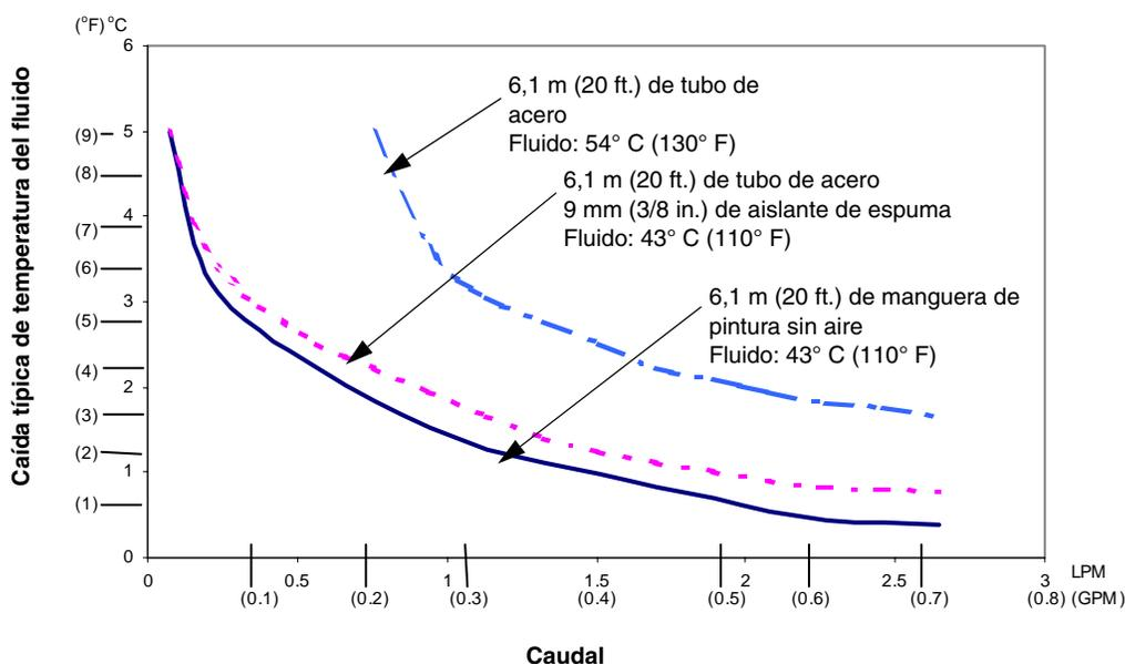
FIG. 2: Caída de temperatura típica
