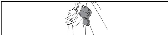
6. Mantenga una parte metálica de la pistola firmemente contra un recipiente de metal y dispare la pistola para descargar la presión.
