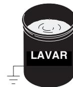
4. Sujete firmemente una pieza metálica de la pistola contra el borde de una lata metálica con conexión a tierra
