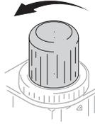
3. Abra la válvula neumática principal de tipo purga (B) de la bomba.
