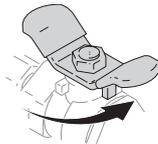
4. Sujete firmemente una pieza metálica de la pistola (T) contra el borde de una lata metálica con conexión a tierra y dispare la pistola.
