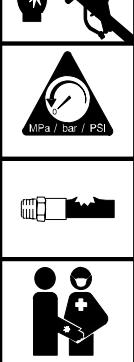
**Peligro de inyección de fluido y alta presión:** por la pulverización o las filtraciones a alta presión se pueden inyectar fluidos en el organismo.
