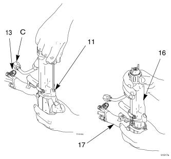
Fig. 16. Barrel Removal
