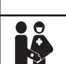
**Perigo de injeção de líquidos e de alta pressão:** a pulverização ou fugas a alta pressão podem injetar líquido na pele humana.
