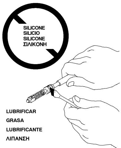
9. Lubrifique os vedantes da nova agulha, utilizando uma massa lubrificante *sem silicone*.
