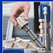
La amplia zona de filtrado reduce las obstrucciones de la boquilla y garantiza un acabado de calidad. El filtro se extrae con la tapa, lo que facilita la limpieza.
