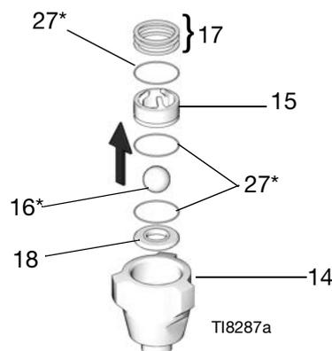
**FIG. 1: Desmontaje de bases Xtreme**
