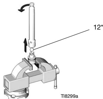
11. Inspeccione la superficie exterior de la varilla de desplazamiento (1) y la superficie interior del cilindro de la base (11) en busca de estrías o desgaste; reemplácelo si estuviera dañado.
