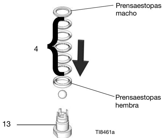
**NOTA:** Para convertir la base a un material de empaquetadura distinto, consulte las secciones de Kits de empaquetaduras. Para conseguir los mejores resultados, empape las empaquetaduras de cuero en aceite antes de montarlas.
