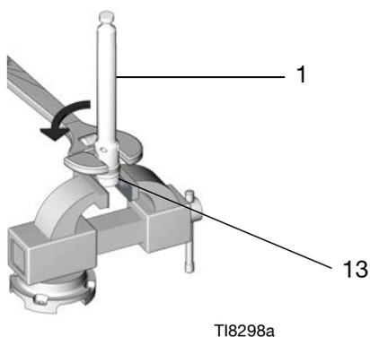
14. Retire los prensaestopas y las empaquetaduras en V (4) de la válvula del pistón (13). Inspeccione la bola del pistón (12\*) y la válvula del pistón en busca de signos de desgaste o daños.
