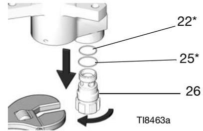
5. Inspeccione las juntas tóricas (22\*, 25\*), el filtro de malla (23) y el soporte del filtro (24).
