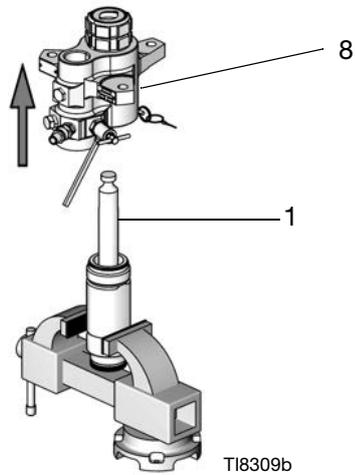
9. Retire el conjunto del cartucho. Retire la junta tórica (27\* o 29\*) de la parte inferior del alojamiento de salida (8), y después desenrosque la tuerca de empaquetadura (2) del cartucho de empaquetadura (7). Retire el prensaestopas hembra, el prensaestopas macho, las empaquetaduras en V (3) y el muelle del cartucho de empaquetadura (7).
