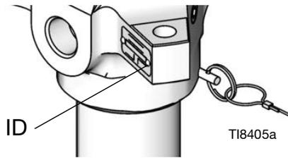
Por ejemplo, el número de pieza de la base de bomba **L180C1** representa la base de bomba (**L**), el volumen de salida (**180**), la estructura de acero al carbono (**C**) y la ausencia de filtro con la pila de empaquetaduras Xtreme Seal™ (**1**).
