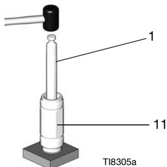
13. Retire cuidadosamente la varilla de desplazamiento de la válvula de pistón. Tenga cuidado de que la bola del pistón (12\*) no se caiga mientras separa la válvula del pistón y la varilla.
